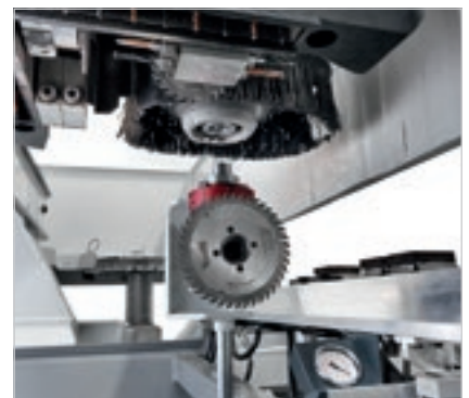
刀具中转装置简化刀具在刀库中的参数设置
