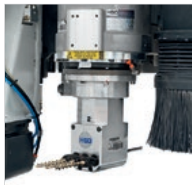
NC 控制的多功能加工单元, 可现实 360度旋转时无限定位。它还可用于 装载定制化的组合刀具, 如锁、铰链、 深水平孔和修边组合刀具。
